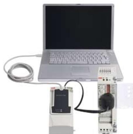
При массовом использовании приводов серии ACS55 для быстрой настройки и контроля параметров на экране ПК очень удобно использовать устройство для настройки и копирования параметров DriveConfig.
